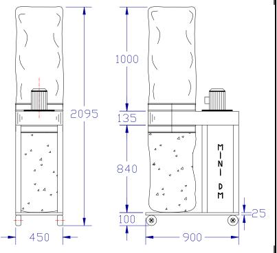
Le mini DM n'est pas seulement silencieux, il est aussi très performant grâce à sa turbine à pales ouvertes incurvées, une surface filtrante efficace avec sa manche filtrante en feutre aiguilleté  $400 \text{ g/m}^2$  et un sac de récupération de grande capacité.
