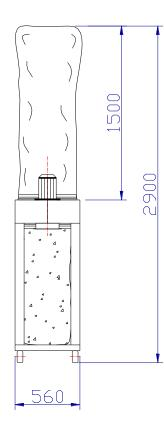
D'une taille supérieure au mini DM, le DM est lui aussi réalisé en tôle d'acier galvanisé, ce qui lui garanti solidité et fiabilité dans le temps.
